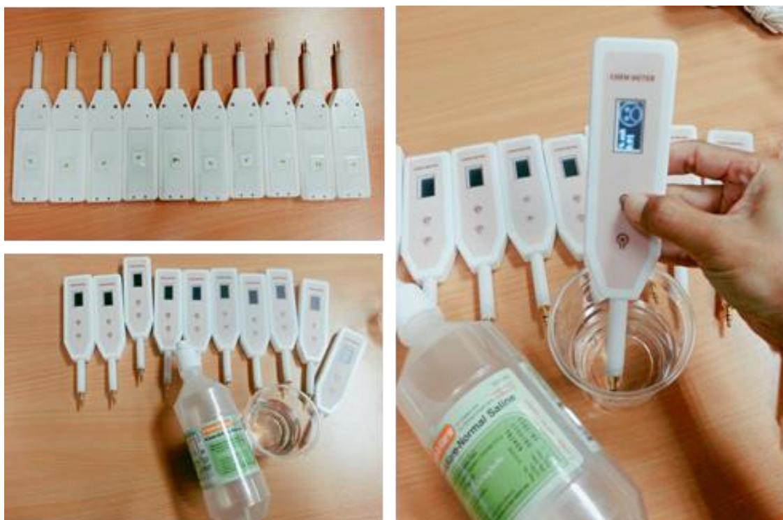
รูปที่ 2 แสดงวิธีทดสอบโดยการเริ่มประเมินกับน้ำเกลือ 0.9% NaCl
