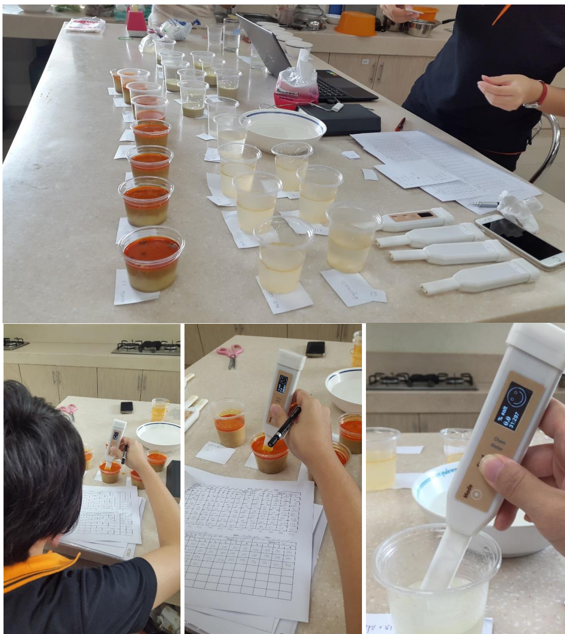
รูปที่ 10 การทดลองวัดค่าความนำไฟฟ้าในตัวอย่างอาหารในแต่ละประเภทที่มีค่าความเค็มแตกต่างกัน
