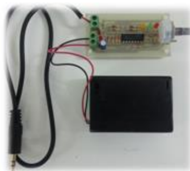
รูปที่ 1 Prototype 1 ของเครื่องวัดปริมาณโซเดียมคลอไรด์ด้วยหลักการวัดแบบ Conductivity
