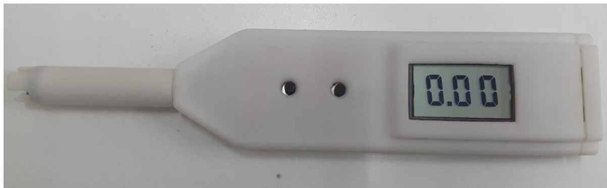
รูปที่ 3 Prototype 3 เครื่องวัดความเค็ม CHEM METER
