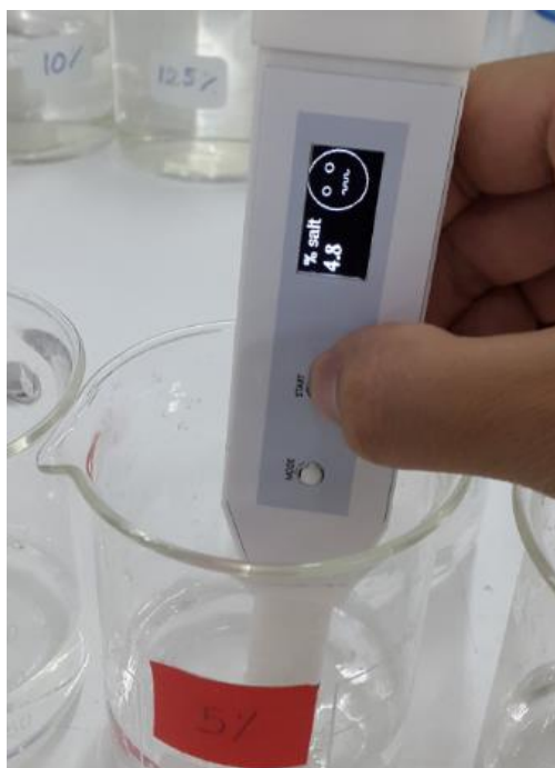
รูปที่ 9 แสดงการวัดค่าความเค็มในตัวอย่างสารละลายกลูโคส 5%
