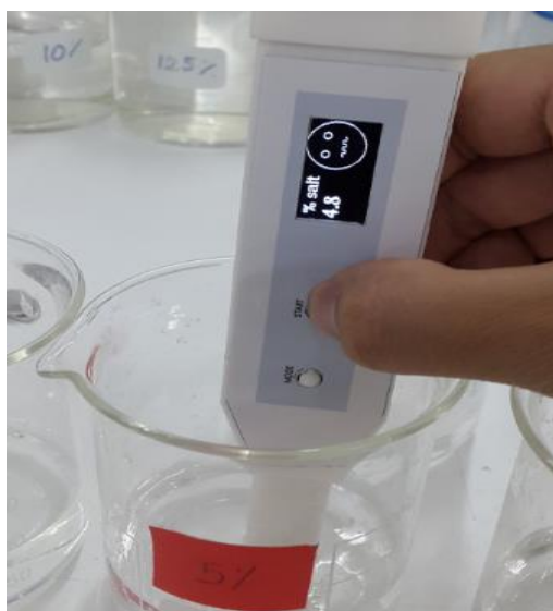
รูปที่ 17 แสดงการวัดค่าความเค็มในตัวอย่างสารละลายเกลือ 5%
