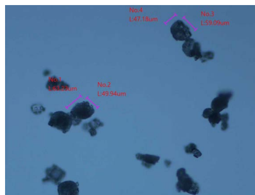
ลักษณะอนุภาคอุณหภูมิเข้า 200 °C
